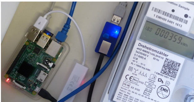
Abb. 8 Messanordnung mit Raspberry Pi 2 und eHZ
